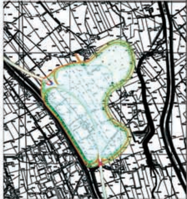
FIG. 8 IPOTESI "B" : bacino in alveo per la laminazione delle piene del torrente Chiampo a Montorso Vicentino - Zermeghedo (corografia 1:100.000, planimetria 1:20.000 e sezioni tipo)
