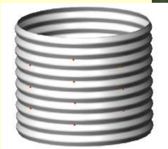
Oltre ai fori per i bulloni, le piastre dovranno essere munite di ulteriori 20 fori per ogni metro di colonna per garantire una migliore azione di drenaggio lungo tutta la verticale. I fori, praticati prima della chiusura, avranno un diametro pari a 5 mm, e comunque tali da non venire intasati dal materiale drenante.
