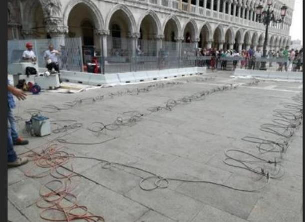
Installazione degli elettrodi per le indagini ERT funzionali ad una valutazione preliminare del rischio archeologico e per la verifica del posizione della condotta dell'acquedotto
