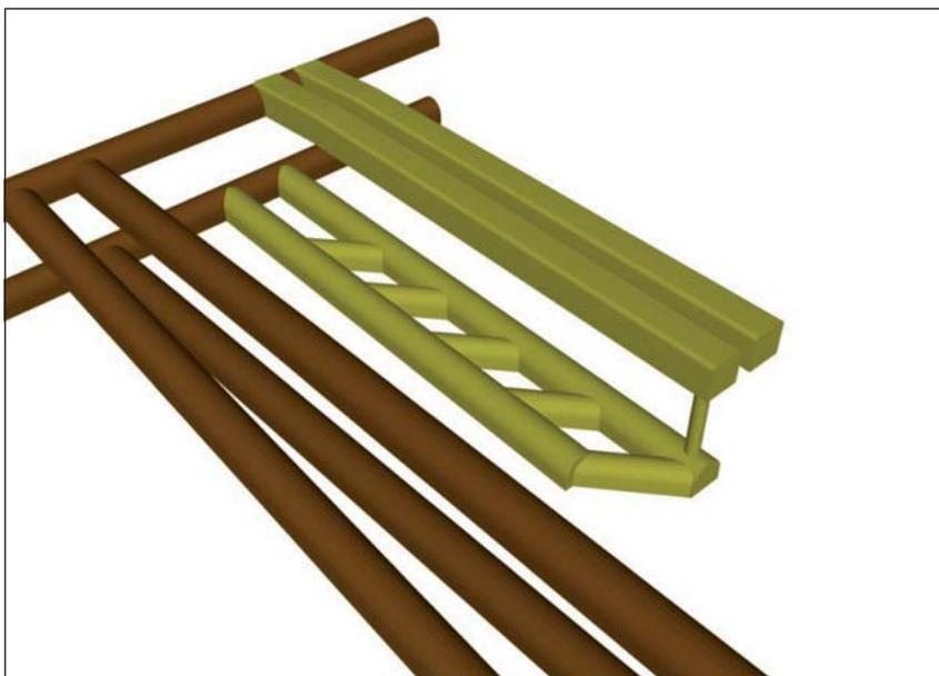
Fig. 55 - Fase 3 di coltivazione per il tipologico della camera di coltivazione con due gallerie di testa e galleria di base fuori asse.
