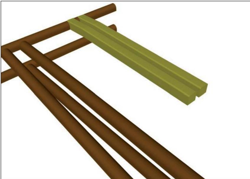
Fig. 53 - Fase 1 di coltivazione per il tipologico della camera di coltivazione con due gallerie di testa e galleria di base fuori asse.
