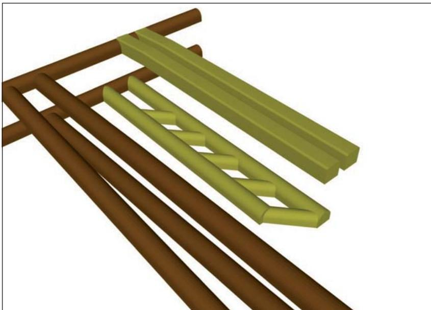
Fig. 54 - Fase 2 di coltivazione per il tipologico della camera di coltivazione con due gallerie di testa e galleria di base fuori asse.
