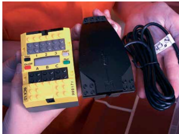
La centralina del robot e il collegamento ad infrarossi col computer.
